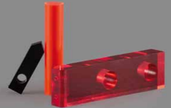
Farbiges Acryl, gefräst, gebohrt und poliert
