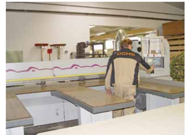
Bearbeitung an der Plattensäge
